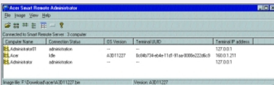
Mit dem Smart Remote Administrator kann der Systemverwalter sehen, welche Terminals an einem Server angemeldet sind und deren Firmware aktualisieren
